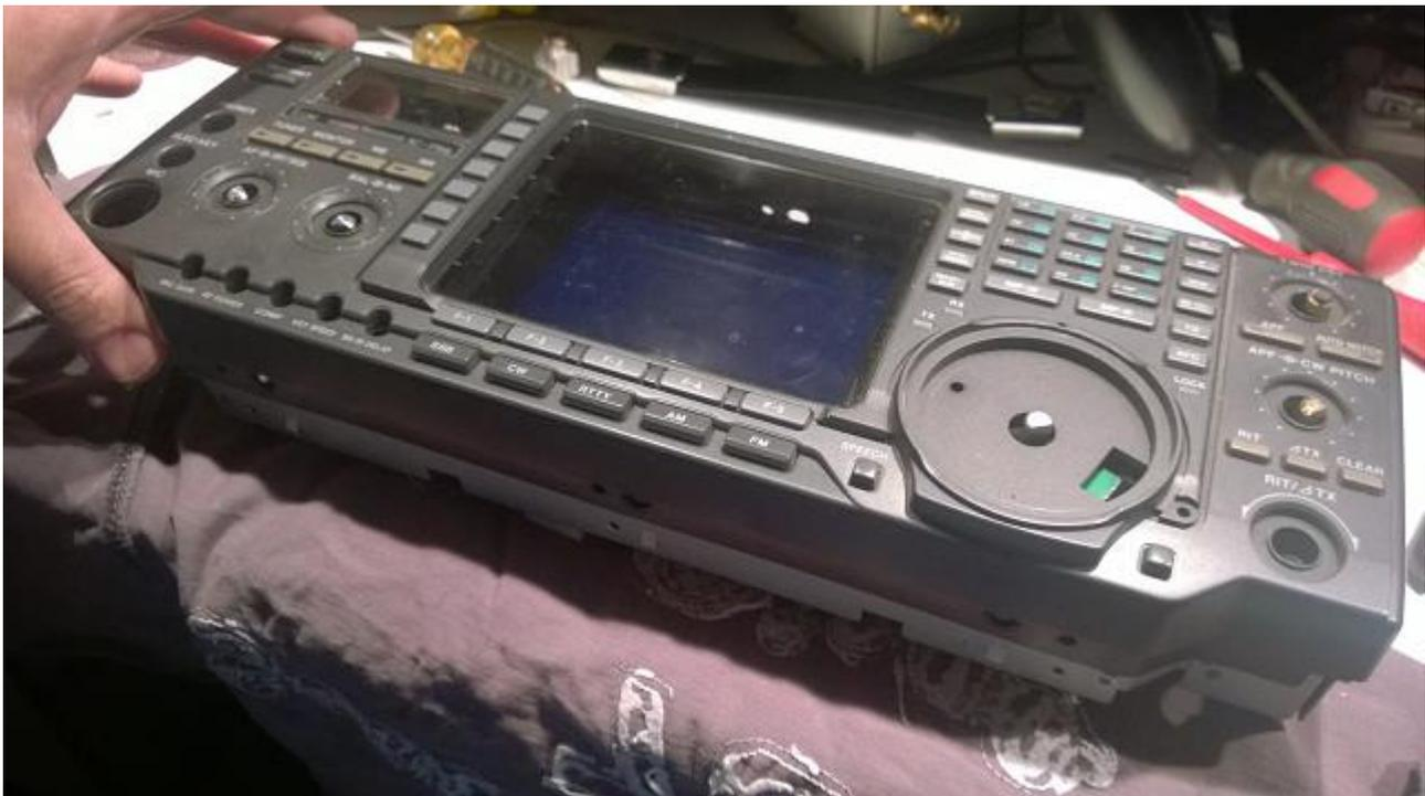
**Il faut obligatoirement déposer la face avant pour enlever les écrous des 2 potentiomètres.**
