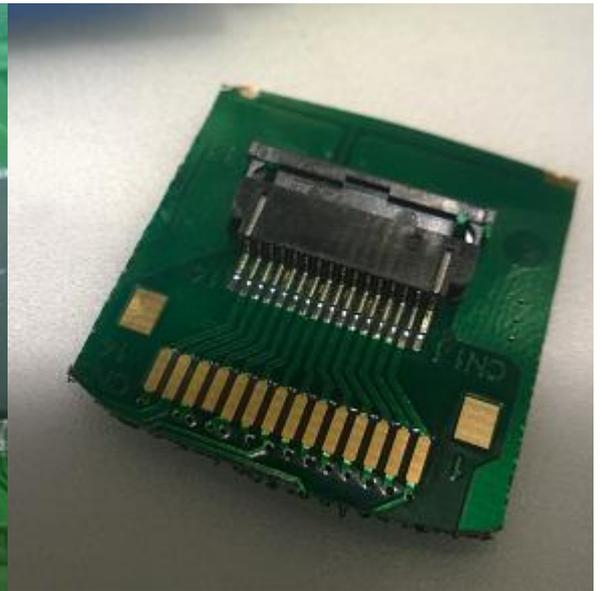
**Avec un fer adapté, une loupe, on soude les fils côté connecteur et côté LCD**
